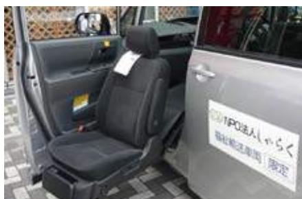
助手席には、自動乗降装置が搭載されています。車の段差が不安な方たも座るだけでラクラク乗降可能です。
